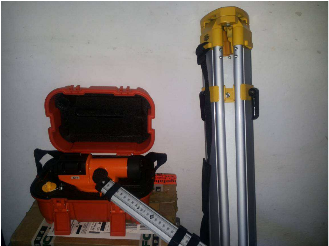
fot.1. Widok zestawu do określania krzywizny stropów.
