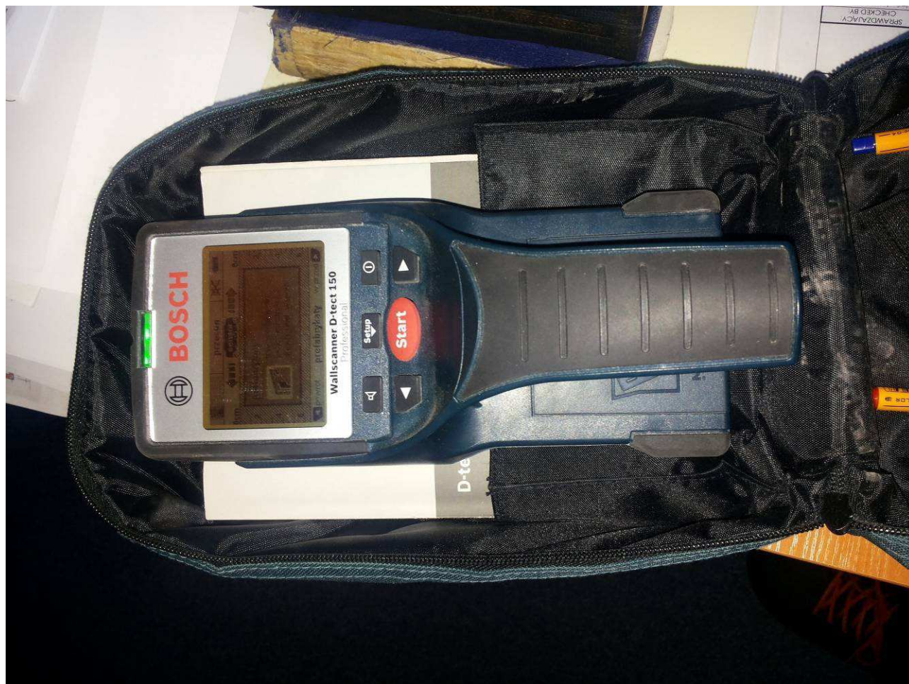
fot.3. Widok detektora BOSCH Wall scanner D-tect150
