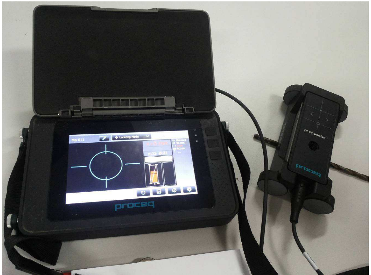
fot.2. Widok detektora Profometer PM-600/PM-630 szwajcarskiej firmy PROCEQ- widoczny monitor oraz sonda pomiarowa (po prawej).
